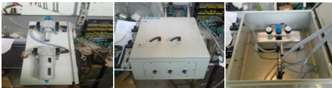
1- تابلوی تست ترمز لو کوموتیو شرکت مینا
